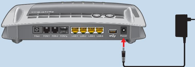
3. Stecken Sie das Netzteil in eine Steckdose der Stromversorgung. Die Leuchtdiode „Power“ beginnt nach einigen Sekunden zu blinken und signalisiert damit die Betriebsbereitschaft der FRITZ!Box.
