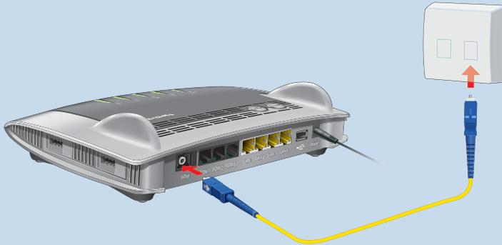
2. Stecken Sie das andere Ende des Glasfaserkabels in die Buchse an Ihrem Glasfaseranschluss.
